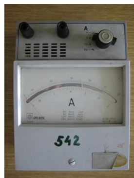
Слика 3. Аналогни амперметар ознаке “Iskra FL0120”
