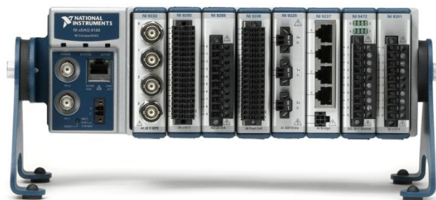
Слика 16. CompactDAQ платформа са разним модулима за различита мерења
