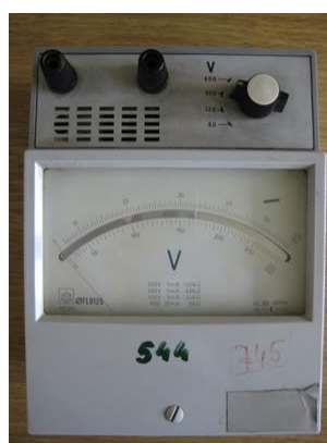
Слика 1. Аналогни волтметар ознаке “Iskra FL0125”
